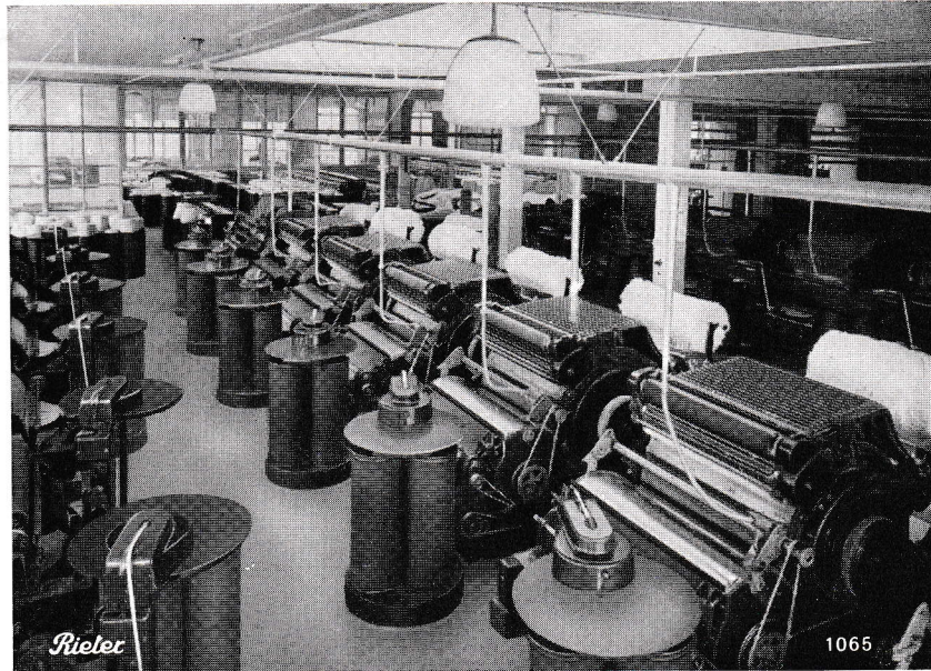
Fig. 4. Cardes avec changement automatique des pots. (S. A. J. J. Rieter & Cie, Winterthur.)
