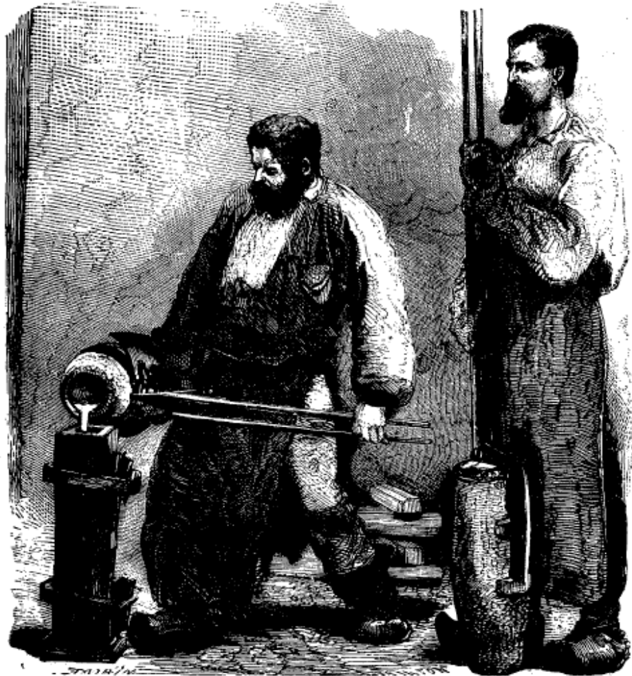
Ancien mode de coulage de l'acier fondu (d'après une photographie de Franck).
