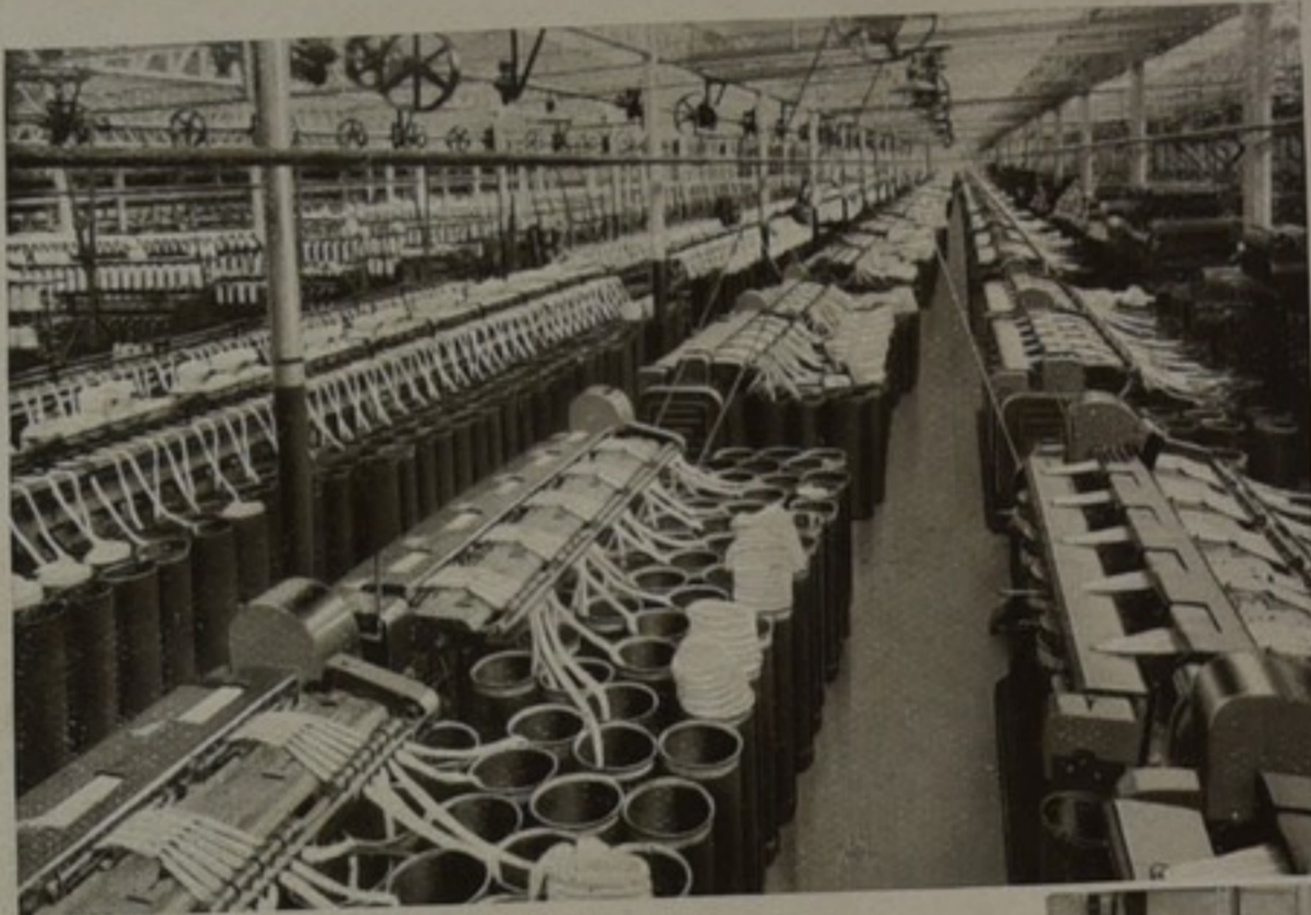
Salle de renvideurs à différentiel d'une filature de laine peignée
